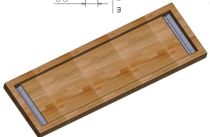
Massivholzplatten rechteckig - Plattenstärke 30 mm mit Randaufdoppelung auf 60 mm
