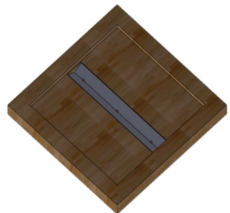
Massivholzplatten rechteckig - Plattenstärke 30 mm mit Randaufdoppelung auf 60 mm
