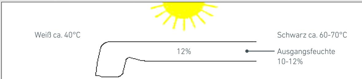
Zunächst einseitige Erwärmung der Plattenoberfläche, später wird die ganze Platte heiß. Durch die feuchtdichte rundum geschlossene Oberfläche kann die Feuchtigkeit nicht entweichen! Somit bewegt sich die Feuchte innerhalb des Plattenquerschnittes in Richtung der unteren Seite. Dadurch wird der obere Teil der Platte trockener, z.B. 8% und der untere Teil feuchter, z.B. 14%.
