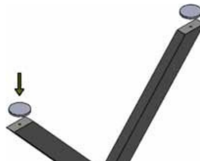
Bodengleiter fertig montiert
