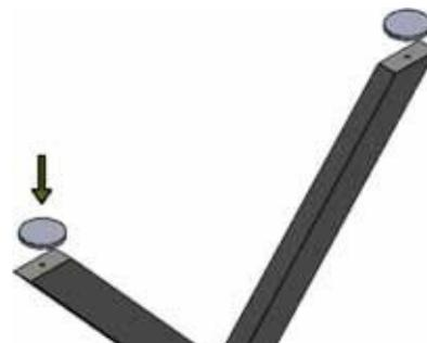
Bodengleiter fertig montiert
